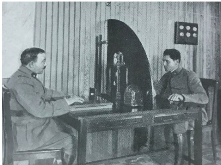
Figure 3.9. Apparatus for testing reaction times. Agesilao Milano, Examen médico de los aviadores (Buenos Aires: Casa Editora de A. Guidi Buffarini, 1923), 26.
