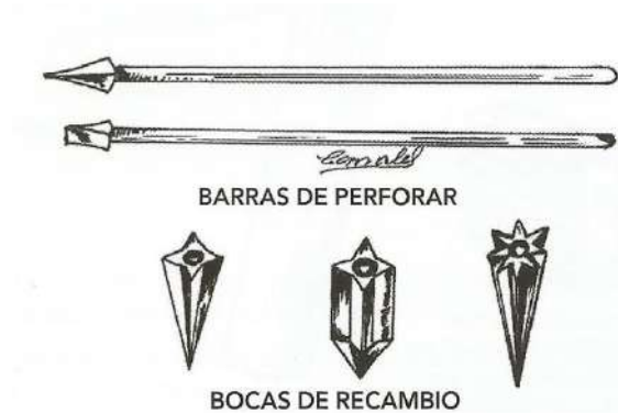
Fig. 32: Barras de Perforar Fuente: Francisco Gómez Canales 379
