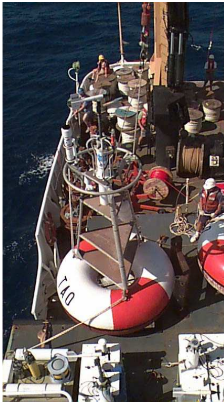
Figure 1.3: En haut à gauche, schéma de principe d'un mouillage ATLAS (Autonomous Temperature Line Acquisition System) de nouvelle génération équipé à la fois de courantomètres sur le câble de la bouée entre 0 et 300 m et d'un mouillage en sub-surface vers 300 m équipé d'un profileur ADCP orienté vers la surface. En haut à droite, récupération délicate du mouillage de sub-surface, de son profileur ADCP, et de ses précieuses informations à 0°,170°W, après 6 mois de bons et loyaux services. En bas, la dernière bouée ATLAS mise à l'eau avant que l'un des moteurs du Ka'imimoana ne lâche.
