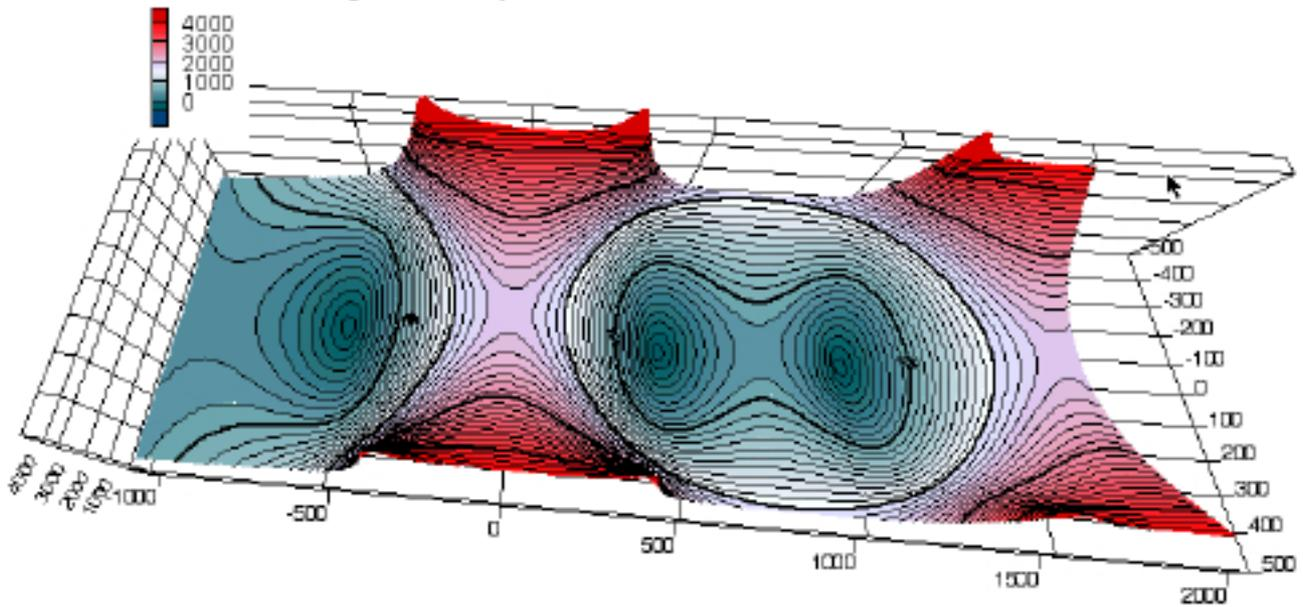
Le champ magnétique nécessaire à son fonctionnement est obtenu avec deux couronnes constituées d'aimants permanents pesant 11kg chacune. Ces deux couronnes sont distantes de 80mm et leur rayon intérieur est de 50mm. Ce système permet de réaliser un confinement magnétique à symétrie de révolution axiale avec un module de champ pour la dernière surface fermée qui atteint 2300 gauss(\*).
