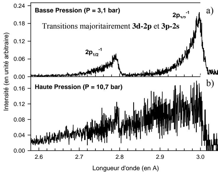
**Figure 1.** Spectres haute résolution du rayonnement X issu d'agrégats de xénon soumis à une impulsion laser IR de 60 fs et un éclairement crête de l'ordre de  $2,9 \cdot 10^{16}$  W/cm<sup>2</sup> pour une pression amont de a)  $P_0 = 3,1$  bar et b)  $P_0 = 10,7$  bar.
