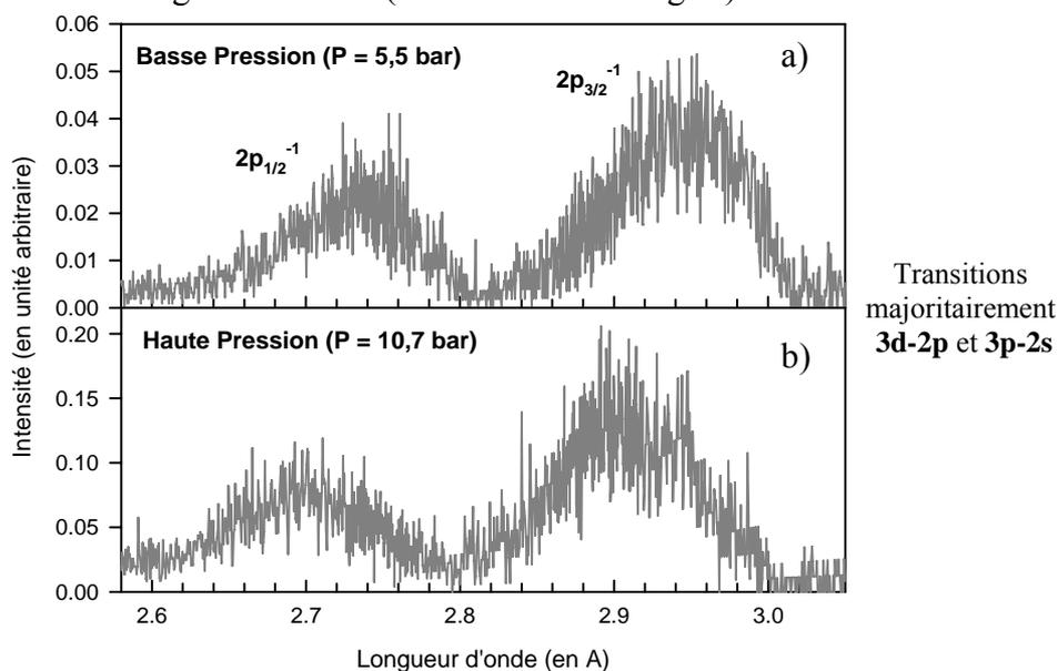
**Figure 2.** Spectres haute résolution du rayonnement X issu d'agrégats de xénon soumis à une impulsion laser UV de 180 fs et un éclairement de l'ordre de  $3,0 \cdot 10^{16}$  W/cm<sup>2</sup> pour une pression amont de a)  $P_0=5,5$  bar et b)  $P_0=10,7$  bar.
