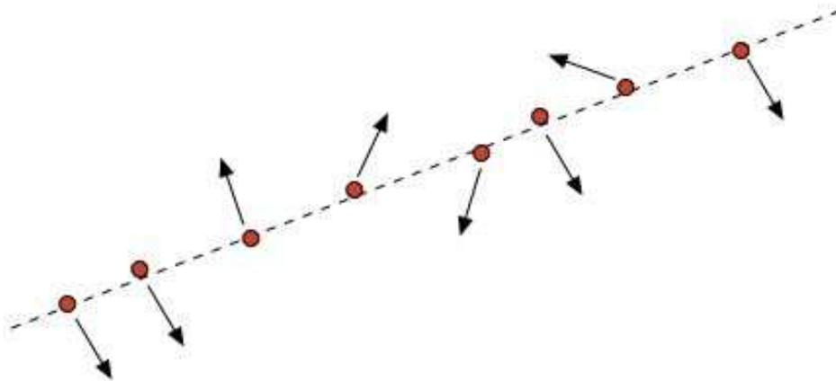
*Figure 1 : Trace et ionisation : les flèches symbolisent les électrons éjectés, les points rouges correspondent aux ions formés sur la trace.*
