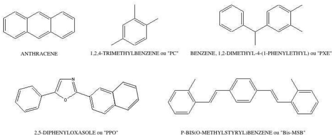
*Figure 3. Les molécules chimiques rencontrées fréquemment dans les liquides scintillants contemporains se divisent en scintillants primaires : 1,2,4-triméthylbenzène ou pseudocumène (PC), 1,2-diméthyl-4-(1-phényléthyl)-benzène (PXE) et en composés fluorescents : 2,5-diphényloxazole (PPO), p-bis(o-méthylstyryl)benzène (bis-MSB) qui permettent une émission lumineuse vers le bleu, plus aisée à détecter.*
