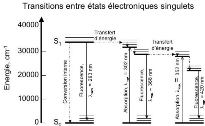
Figure 4. : Schéma des transferts d'énergie dans le mélange scintillant pseudocumène, butyl-PBD, bis-MSB
