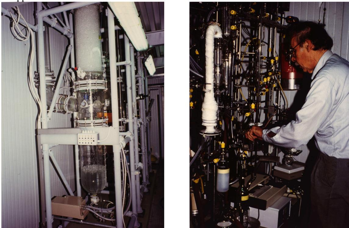
*Figure 6a et 6b. Le dispositif d'extraction dans Gallex avec sa colonne de verre munie de torons où le chlorure de germanium est piégé. Sur le banc de synthèse, on transforme ce chlorure en germane (GeH<sub>4</sub>) et l'on remplit le compteur proportionnel où l'on détectera la désintégration des <sup>71</sup>Ge radioactifs.*
