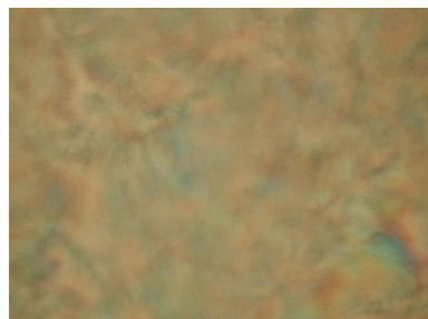
FIG. 1.6: Phase lamellaire observée en microscopie à polarisation
