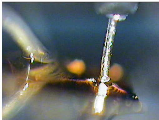
FIG. 3.7 – Photographie de la jonction tunnel à l'interface liquide-solide..
