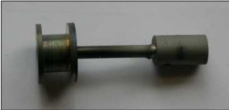
*Fig1 et 2 : cible carbone et porte cible*
