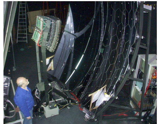
FIG. 4.4 : Photo d'un des télescopes de Los Leones, l'un des détecteurs de fluorescence de l'observatoire Pierre Auger.
