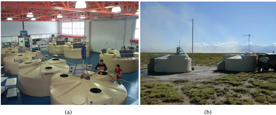
FIG. 4.18 : (a) Photo du "building center" où les cuves sont préparées avant leur installation dans la Pampas. (b) Installation d'une cuve de production (à droite) à côté d'une cuve prototype de l'Engineering Array (à gauche).
