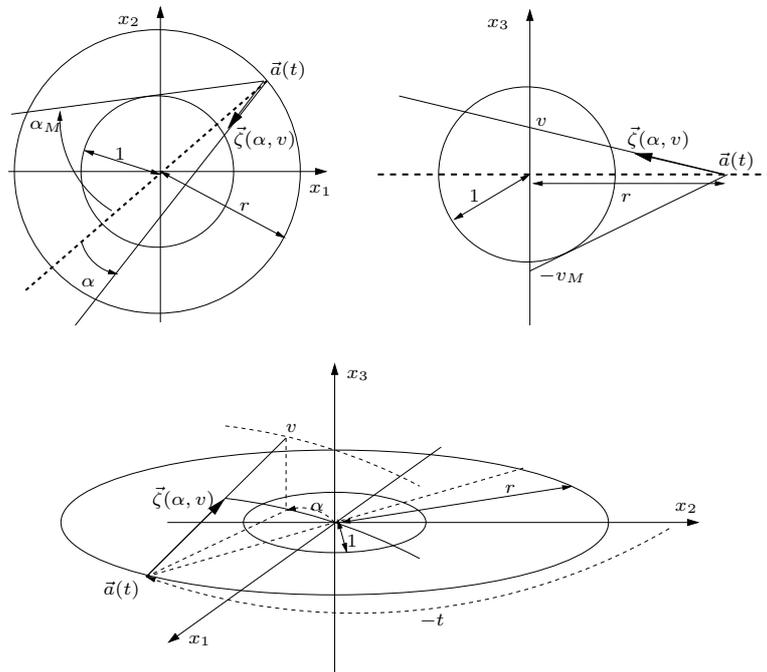
FIG. 3 – Paramètres d’acquisition en géométrie CB sur un détecteur cylindrique virtuel passant par l’axe de rotation (le détecteur virtuel ne sert qu’à repérer les données par  $(t, \alpha, v)$ , le détecteur réel est en général diamétralement opposé à la source, sur le même cercle de rotation).
