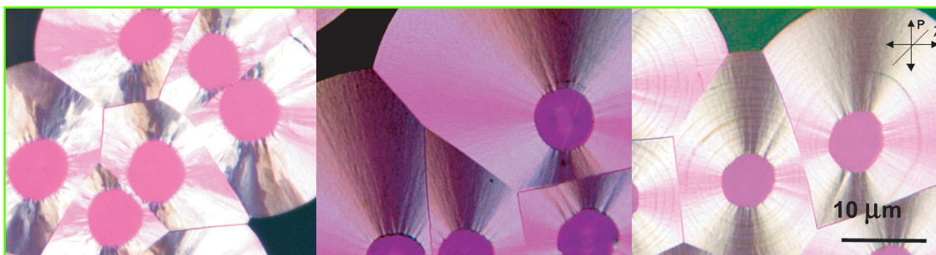
Figure 6 - Les trois grandes familles de pyrocarbones vues en microscopie optique au sein de composites. De gauche à droite : laminaire rugueux, laminaire sombre et laminaire régénéré.
