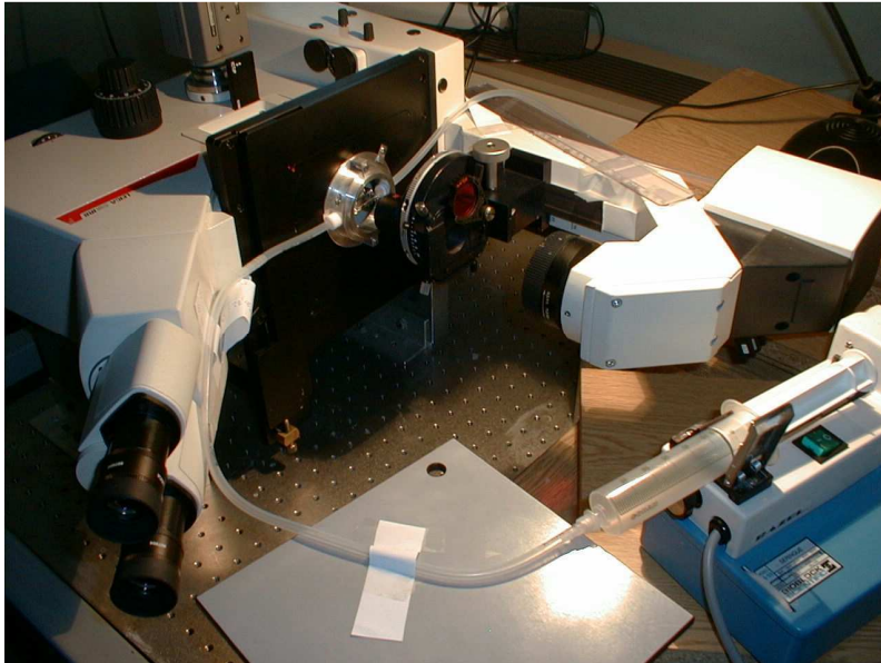
Figure 2_13: Microscope couché pour permettre la vue de côté (tiré de Abkarian, 2002).
