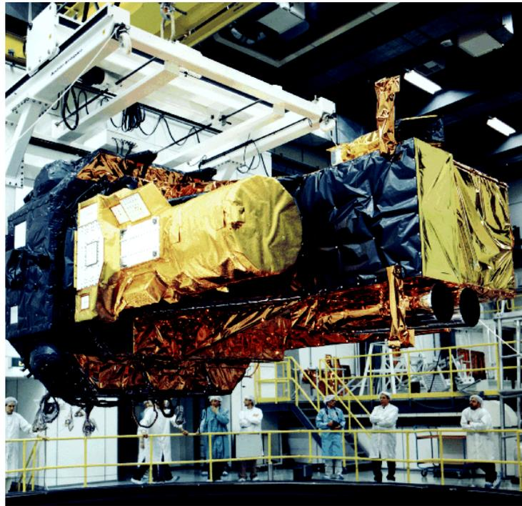
FIG. 1.1: Modèle de qualification du satellite *INTEGRAL*.
