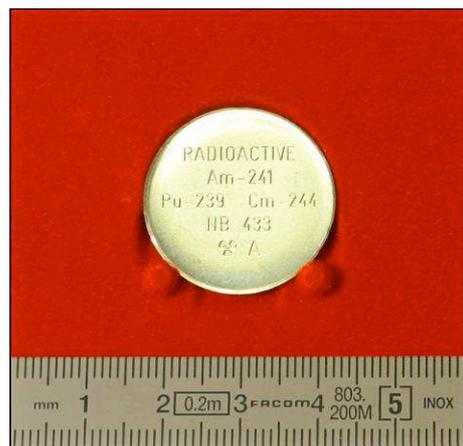
Figure 22 : Source radioactive étalon NB 433 (3 alphas).
