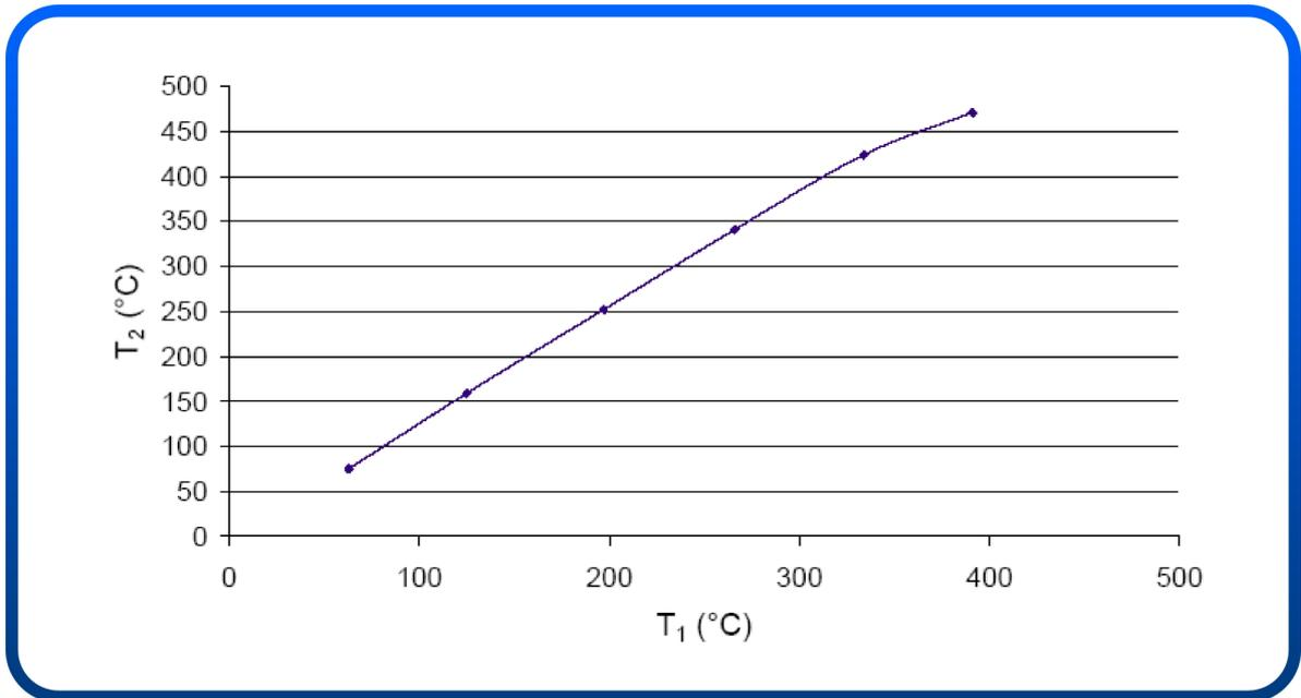
**FIG. 1.5** *Courbe d'étalonnage des fours.*  $T_1$  correspond à la température donnée par le thermocouple du four tandis que  $T_2$  est celle donnée par le thermocouple de la plaquette témoin. Figure reproduite d'après la thèse de M. Koudia [15].
