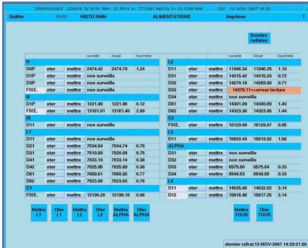
Figure 4-19 : Ecran de l'application surveillance.
