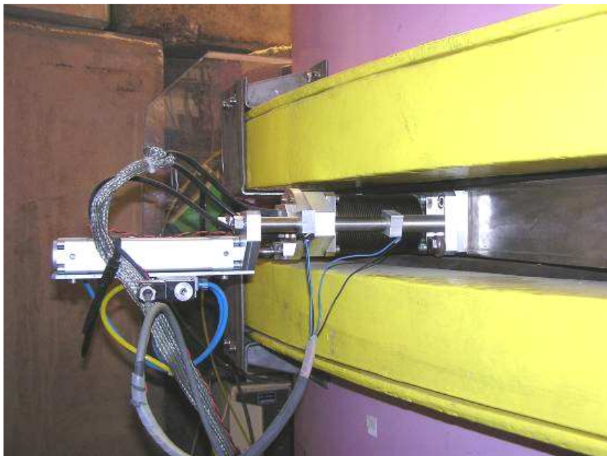
Figure 4-37 : Photo de la mécanique escamotable des sondes RMN
