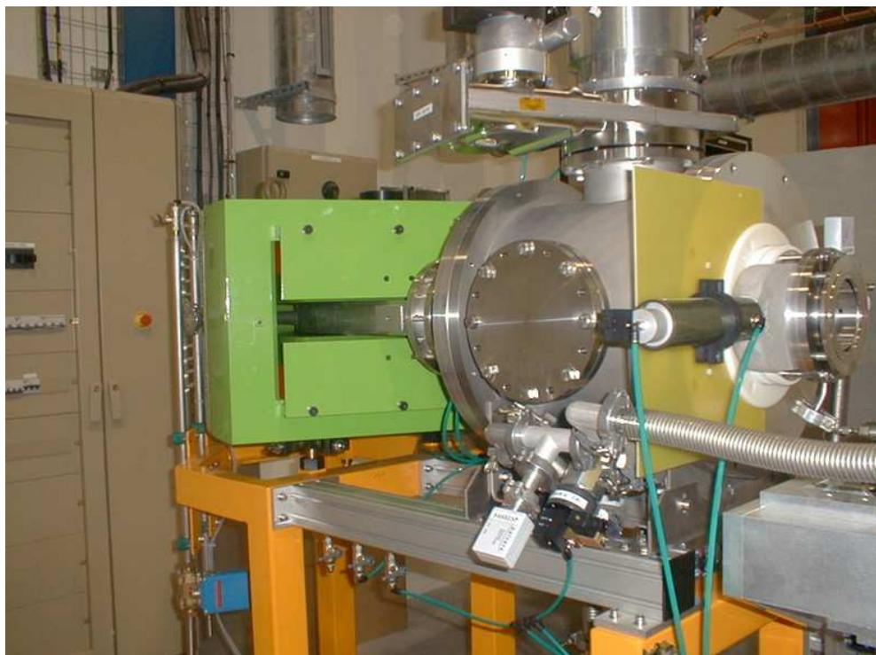
Photo N° 5: Enceinte d'extraction et dipôle électromagnétique
