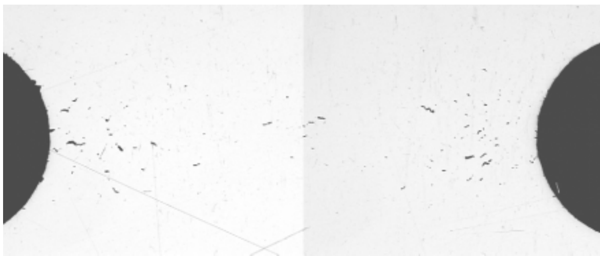
Figure 210 : Coupe longitudinale d'une éprouvette FLE 1-6 en acier 316L(N) à l'état hypertrempé testée en fluage à 600^{\circ}\text{C} sous 320 \text{ MPa} , interrompu après 3094 heures, diamètre minimal après déformation: 5.65 \text{ mm}
