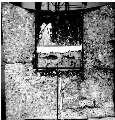
Figure 2-6 : Essai d'interaction corium-béton COTELS D-8 (Maruyama et al., 2006)
