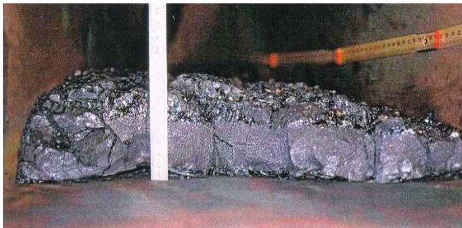
Figure 2-55 : Coupe de la coulée de corium FARO L26-S (d'après Cognet et al. , 2001)
