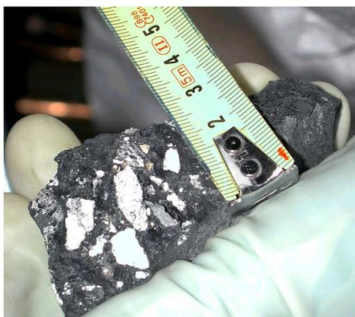
**Figure 8-13: Echantillon de corium contenant des graviers**
