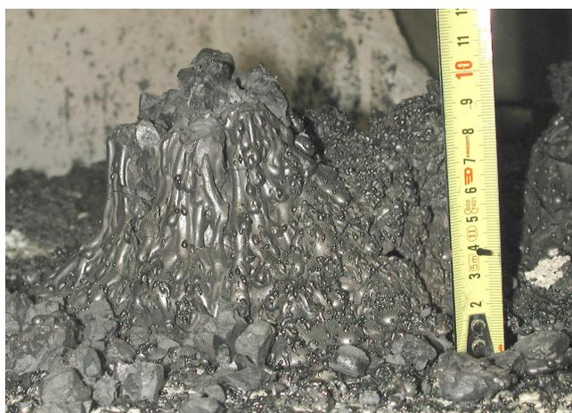
Figure 8-21. Un des volcans observés à la surface du bain de corium
