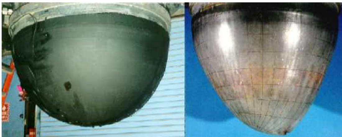
Figure 2-3 : Maquette de cuve avant/après l'essai de rupture LHF (Chu et al., 1999)
