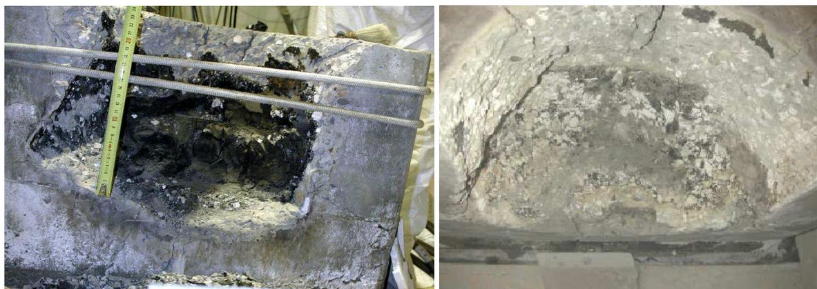
**Figure 8-12: Vue de la section d'essais en béton, après démontage partiel du corium.**
