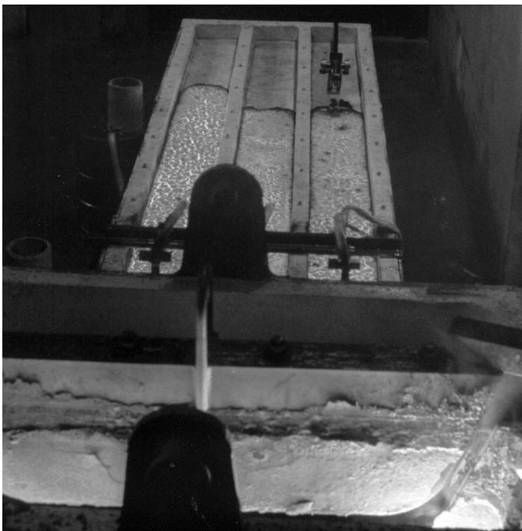
Figure 2-54: Essai COMAS EU-2B d'étalement sur trois substrats différents.
