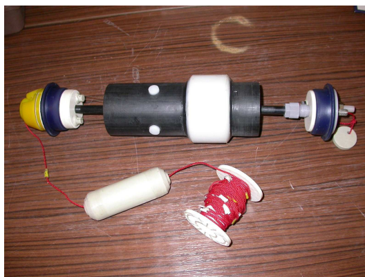
Photographie 8 : Préleveur manuel à fermeture actionnée par un poids en plomb gainé.
