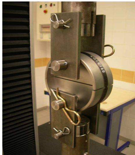
Fig. 3. Dispositif d'essai de traction sur anneaux.
