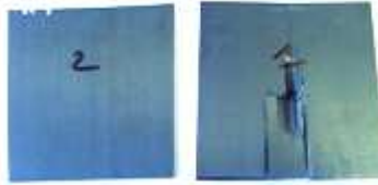
Fig. 6. Echantillons avant et après impact.
