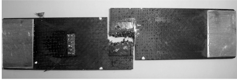
Fig. 11. Faciès de rupture de l'éprouvette à double entaille décalées.
