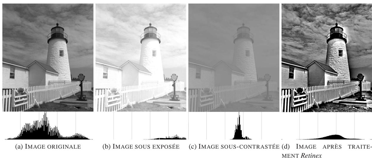
FIG. 1.8: EXEMPLE DE VUES DU PHARE (a) ORIGINALE, (b) (c) PRÉSENTANT UNE MAUVAISE RÉPARTITION DES TONS ET (d) TRAITÉE PAR L'ALGORITHME Retinex .
