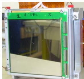
Figure 2.12 – Si à pistes : 1 er étage du télescope MUST2, avec une épaisseur de 300 \mu\text{m} et une surface active de 10 \times 10 \text{ cm}^2 .
