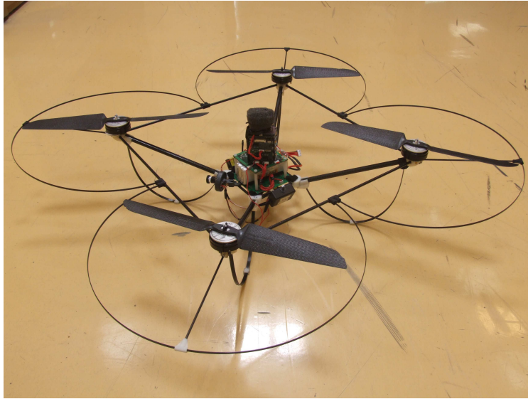
FIGURE 6.1 – Le quadrirotor développé au CEA LIST
