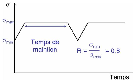
Figure 6 : chargement trapézoïdal cyclique
