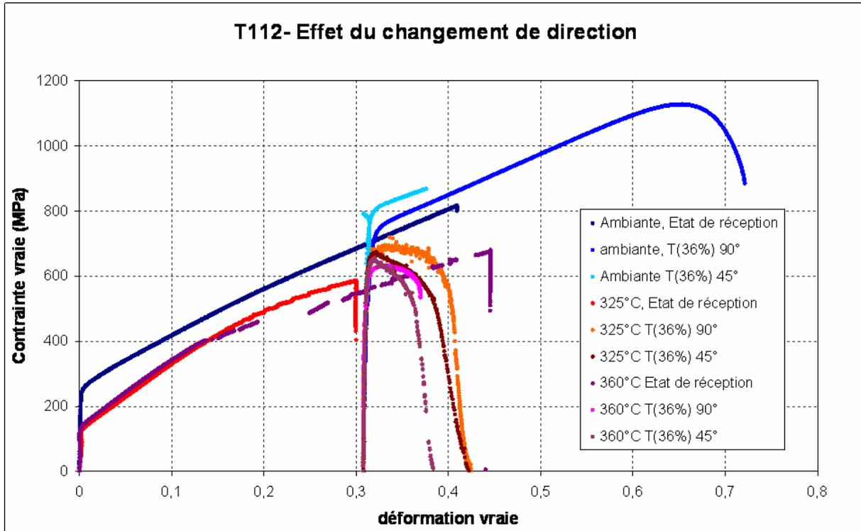
Figure 4: Effet du changement de direction pour le 304L (tôle T112),  $\dot{\epsilon} = 10^{-3} \text{ s}^{-1}$
