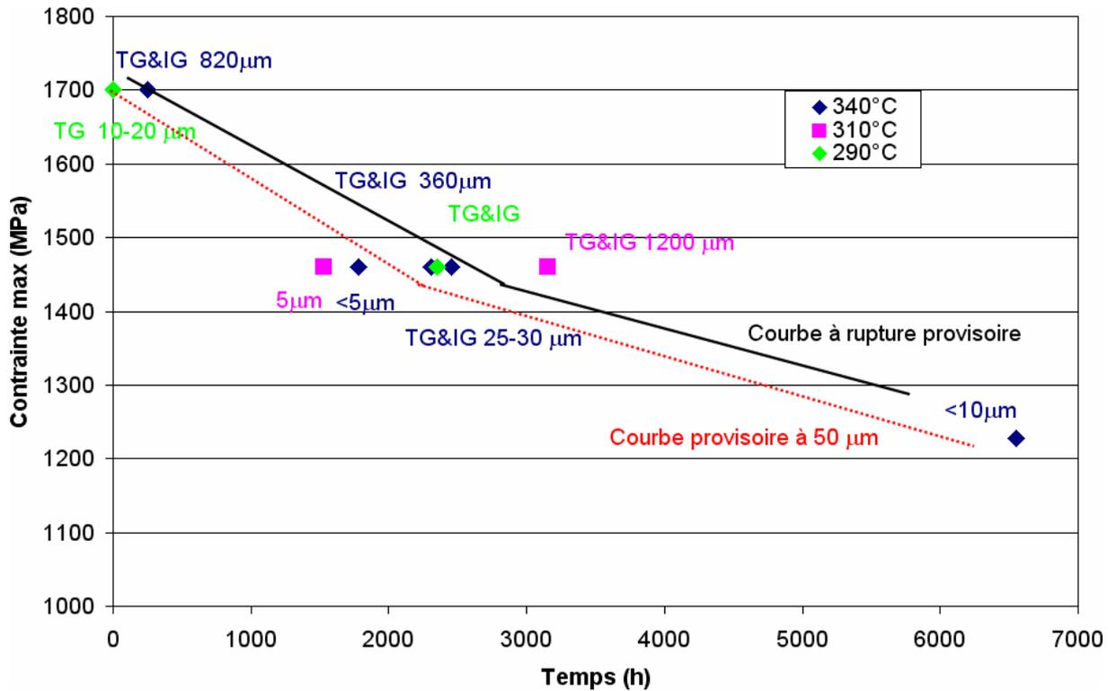
Figure 7 : Courbe contrainte en fonction du temps pour un critère d'amorçage fixé à 50μm
