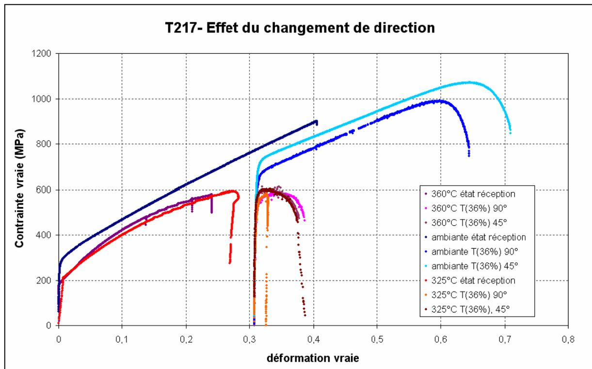
Figure 5 : Effet du changement de direction pour le 316L A (tôle T217),  $\dot{\epsilon} = 10^{-3} \text{ s}^{-1}$
