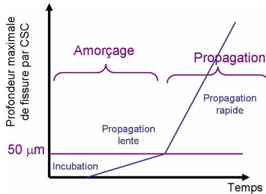
Figure 1 : Définition du critère d'amorçage des fissures
