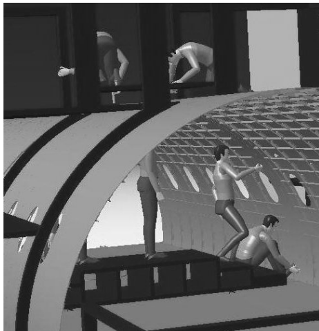
Figure 3.1 : Prototypage de montage dans le domaine de l'aéronautique à l'aide de mannequins virtuels
