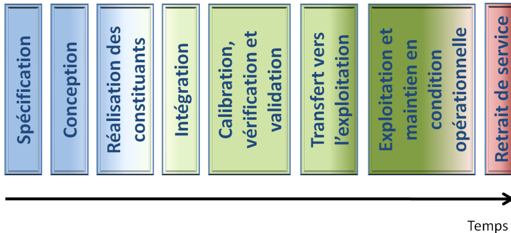
Figure 3.1 – Phases du cycle de vie d'un système.
