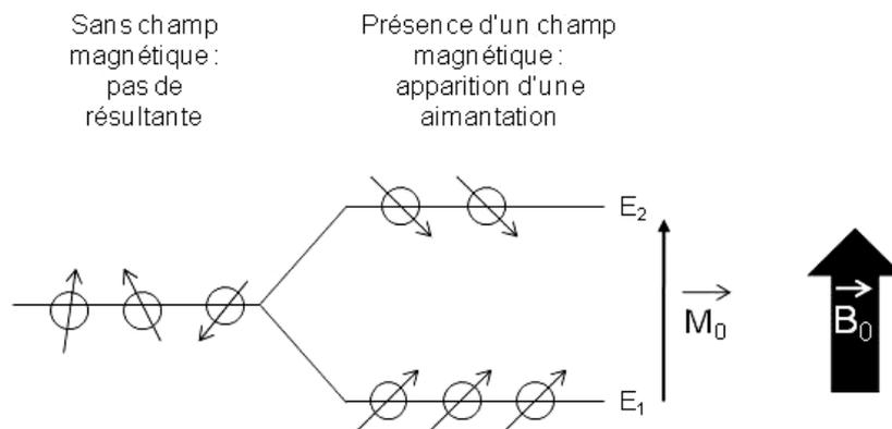
Figure I.1. Répartition des spins sur les niveaux d'énergie et apparition d'une aimantation  $\overline{M}_0$  en présence d'un champ  $\overline{B}_0$ .
