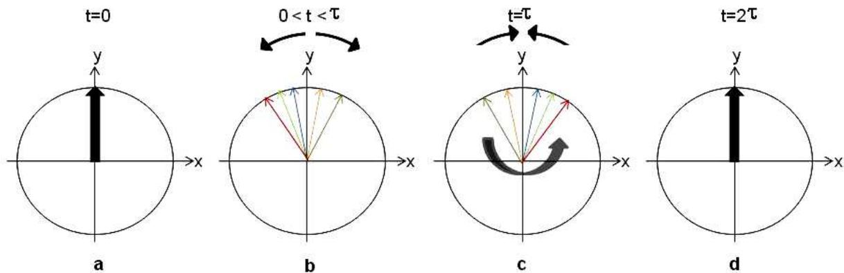
Figure I.7. Principe de l'écho de spin. A  $t=0$ , les spins sont basculés dans le plan transverse à la suite d'une impulsion de  $90^\circ$  selon  $x$  (a). Pendant la relaxation, ils se déphasent selon leurs fréquences de Larmor respectives jusqu'au temps  $t=\tau$  (b) auquel intervient une impulsion de  $180^\circ$  selon  $y$ , qui va avoir pour conséquence d'inverser leur phase (c). Ainsi, au temps  $t=2\tau$ , les spins sont tous en phase, et donnent lieu à un écho (d).
