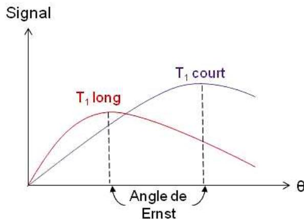
Figure I.11. Exemples d'angles de Ernst pour un TR choisi en fonction du  $T_1$  de l'objet imagé (séquence d'imagerie rapide à TR court). Le signal est d'autant plus important que l'angle est élevé.
