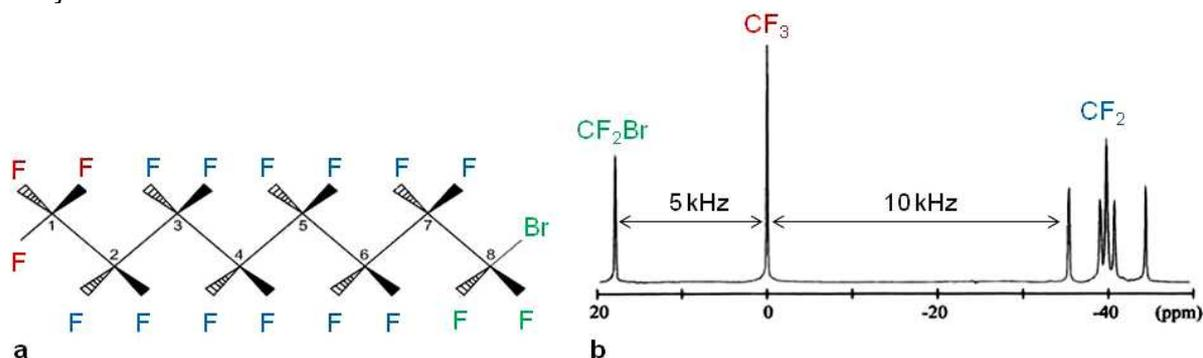
Figure II.5. Représentation de Cram de la molécule de PFOB (a) et spectre  $^{19}\text{F}$  correspondant (b). Les couleurs indiquent la correspondance entre les groupements chimiques et les résonances, les valeurs de déplacement chimique en fréquence sont indiquées pour un champ magnétique de 7 T.
