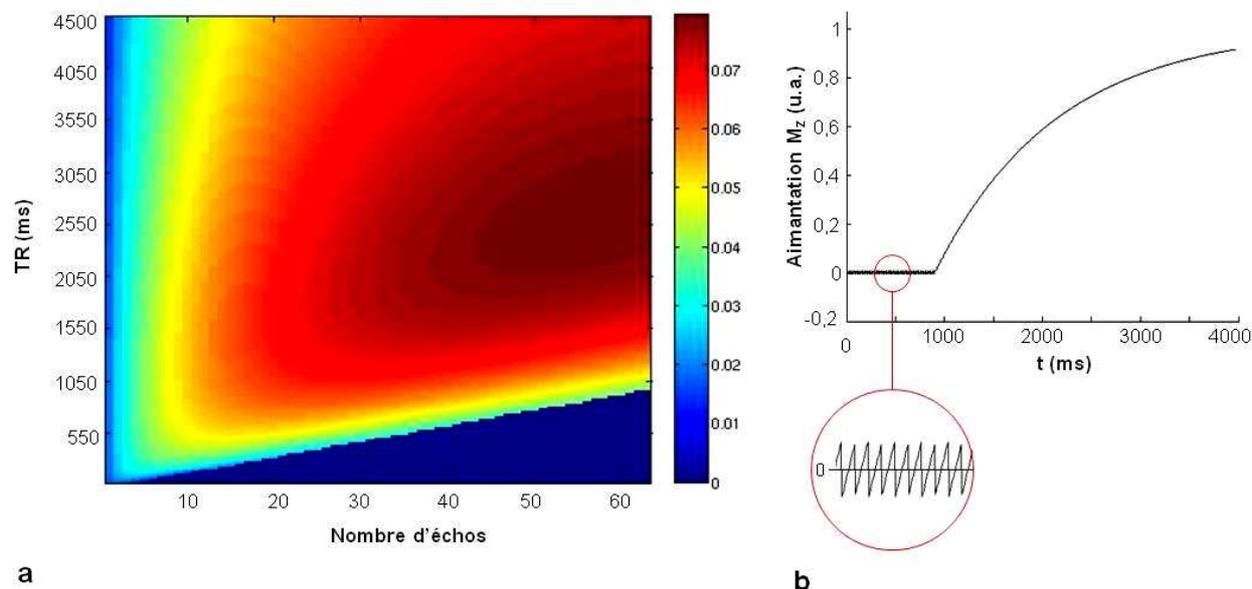
**a** *Figure III.7. (a) Simulation de la sensibilité normalisée obtenue pour les différentes combinaisons  $n_e/\text{TR}$ , avec les temps de relaxation trouvés à  $20^\circ\text{C}$ . La zone bleue sombre en bas correspond aux combinaisons  $n_e/\text{TR}$  impossibles (durée du train d'échos supérieure au TR) (b) Evolution de l'aimantation  $M_z$  pour la combinaison choisie 60 échos/4000 ms, avec détail de son oscillation pendant le train d'échos.*
