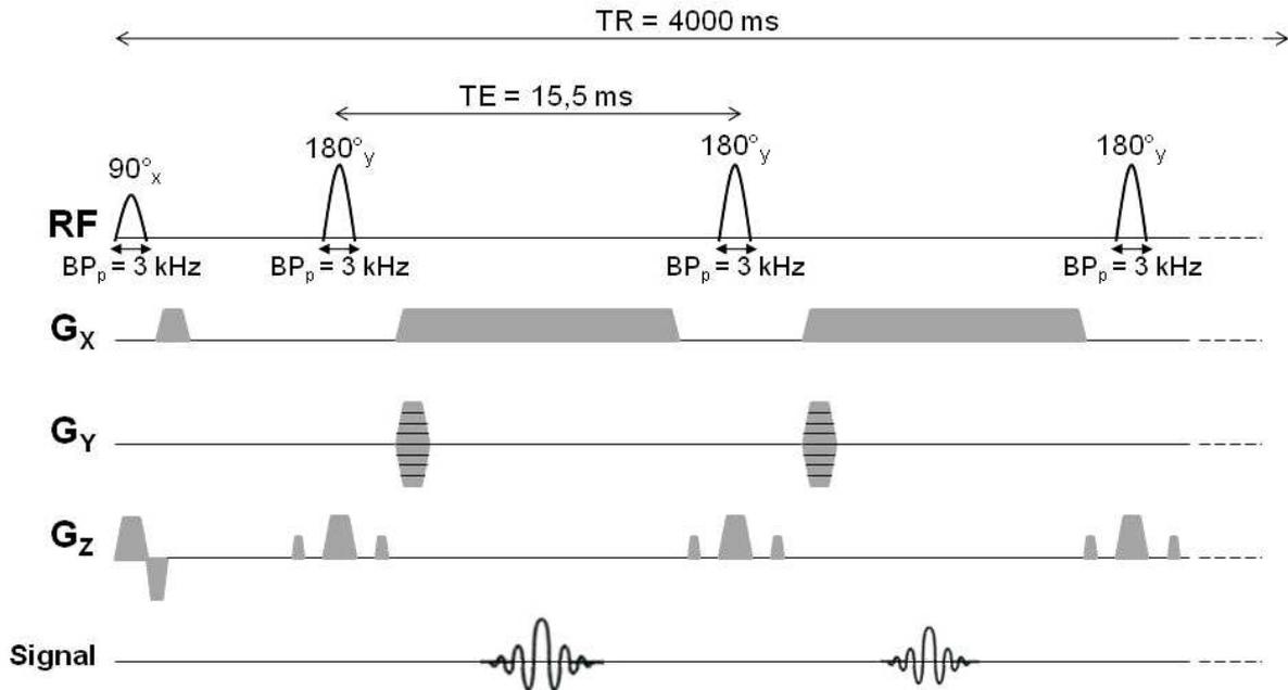
Figure III.8. Chronogramme de la séquence MES optimisée pour l'imagerie du  $\text{CF}_3$  du PFOB. Le chronogramme complet comprend 60 impulsions de  $180^\circ$ , de bande passante ( $\text{BP}_p$ ) 3 kHz afin de n'inverser que le  $\text{CF}_3$ , et espacées de 15,5 ms pour bénéficier d'un  $T_2$  long. Par ailleurs, la bande passante d'acquisition faible de 5 kHz permet d'acquérir le signal sur une durée d'environ 12 ms, soit 80% du TE (axe  $G_x$ ).
