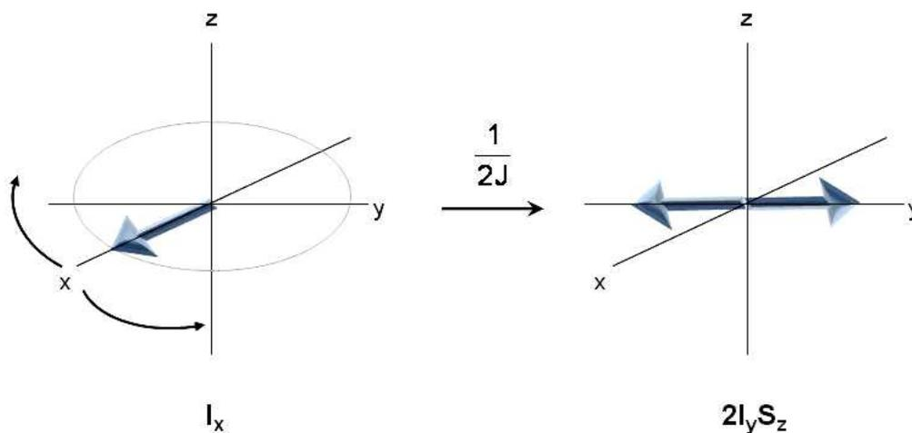
Figure I.6. Evolution de l'opérateur densité en présence d'un couplage  $J$  : après une impulsion de  $90^\circ$ , les spins sont dans l'état de cohérence  $I_x$  (composantes en phase). Ce dernier va évoluer sous l'effet du couplage jusqu'à être dans le mode antiphase  $2I_yS_z$  après un temps  $t=1/2J$ . Ses composantes étant en opposition de phase dans le plan transverse, il n'en résulte aucun signal mesurable.
