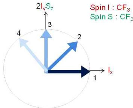
Figure III.2. Oscillation de l'opérateur densité  $\rho$  (flèches bleues) entre les modes de cohérence  $I_x$  et  $2I_yS_z$ . On observe le spin I : après une impulsion de  $90^\circ$ ,  $\rho$  est selon  $I_x$  (1). Sous l'effet du couplage  $J$ ,  $\rho$  évolue au cours du temps jusqu'à être complètement dans le mode non observable  $2I_yS_z$  (2 et 3). Le signal commence à réapparaître lorsque  $\rho$  continue d'évoluer et s'écarte de ce mode (4).
