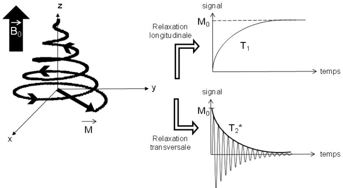
Figure I.4. Relaxation de l'aimantation après une impulsion d'angle  $90^\circ$ . Selon  $z$ , le signal repousse selon la constante  $T_1$  jusqu'à retrouver sa valeur initiale, alors que dans le plan  $xy$ , le signal décroît selon la constante  $T_2^*$  jusqu'à s'annuler. La relaxation s'accompagne d'une précession autour de l'axe  $z$  selon lequel est dirigé  $\vec{B}_0$ .
