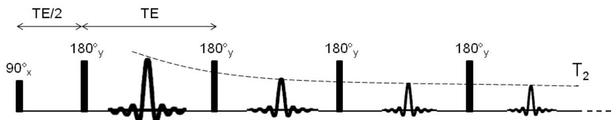
Figure I.8. Principe de la séquence CPMG : une impulsion de  $90^\circ$  selon  $x$  à  $t=0$  est suivie d'impulsions de  $180^\circ$  selon  $y$  survenant à intervalles réguliers  $TE$ . Chaque impulsion de  $180^\circ$  génère un écho. La mesure du signal obtenu à chaque écho permet la mesure du  $T_2$ .
