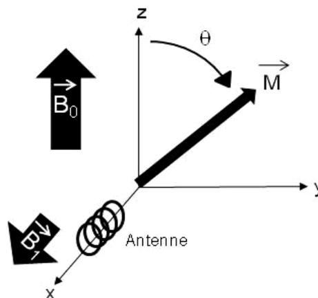
Figure I.3. Effet d'une impulsion RF sur l'aimantation : initialement selon  $z$ , elle est basculée d'un angle  $\theta$  par le biais du champ magnétique  $\vec{B}_1$  généré par une antenne radiofréquence (par souci de lisibilité, la précession simultanée selon  $z$  à la fréquence  $\omega_0$  n'est pas représentée).
