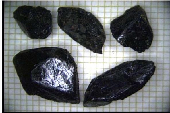
**Fig. 3.8** – Mono-cristaux de DMA-CuCl<sub>3</sub> synthétisés au Japon par Y. Inagaki.
