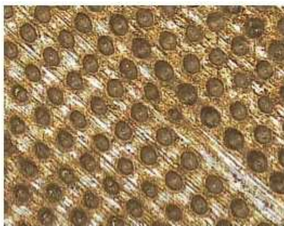
FIGURE 2.6 – Image d'une série de trous d'impact du faisceau laser sur une cible solide d'aluminium.
