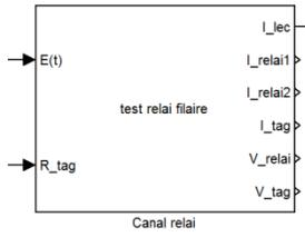
Figure Annexes-19 – Bloc Simulink du relais filaire
