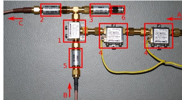
Figure III-5 – Prototype du « prouveur » : Le circuit 1 représente le mixer. Le signal du « vérifieur » arrive par A, B est l'oscillateur de fréquence  $f_{\Delta}$ . Les circuits 2 et 3 sont les filtres permettant de choisir l'une ou l'autre des deux bandes de fréquences
