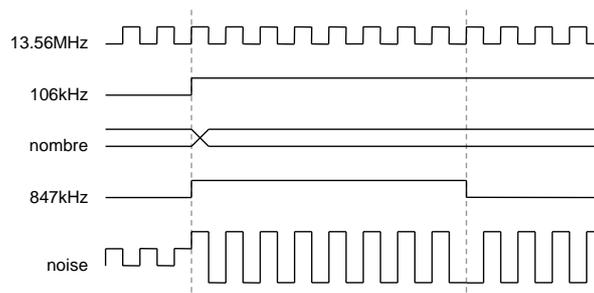
Figure V.16 – Génération du bruit modulé numérique
