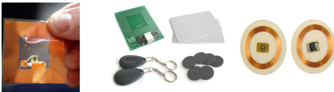
Figure I-1 – Exemples de tags RFID
