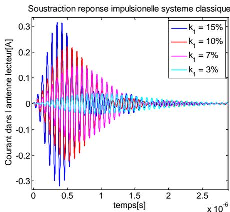
Figure IV-18 – Soustraction des réponses pour un système sans contact
