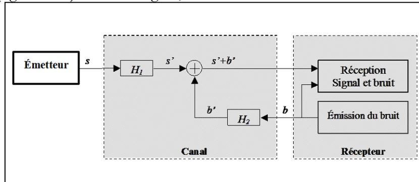
Figure V.46 – Convolutions subies par le signal et le bruit
