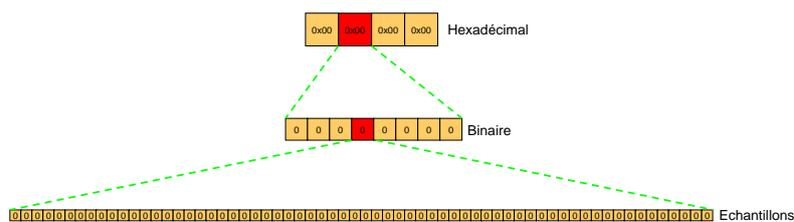
Figure III-34 – Génération de la séquence à corrélérer
