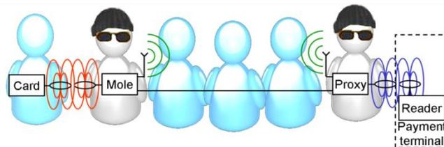
Figure II.23 – L'attaque relais
