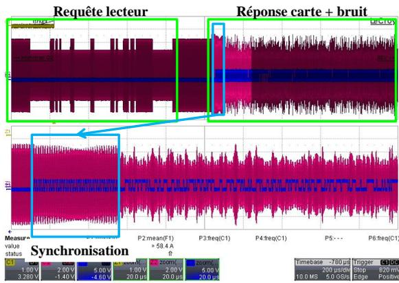
Figure V.34 – Effet du bruit sur le champ magnétique
