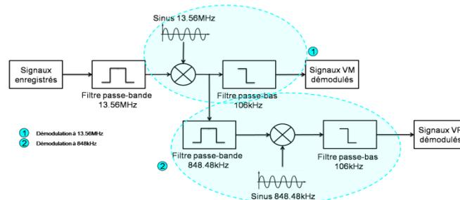
Figure II.5 – Synoptique du fichier de traitement Matlab
