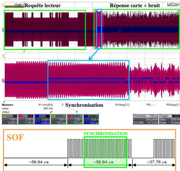
Figure V.23 – Phase de synchronisation en ISO14443-B
