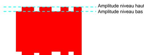
Figure III-7 – Niveau d'amplitude d'une modulation d'amplitude
