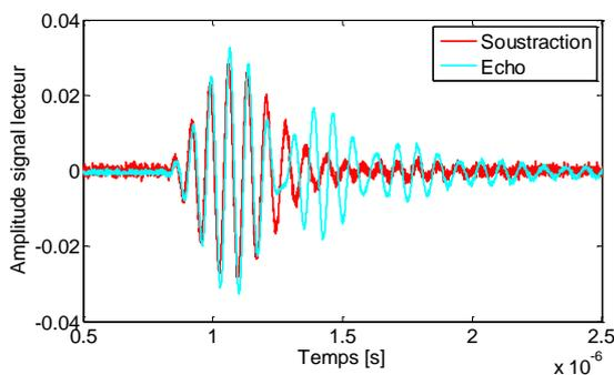
Figure IV-38 – Comparaison de l'écho et de la soustraction du signal au niveau du lecteur avec une carte de coefficient de qualité  $Q=188$
