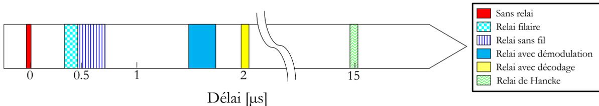
Figure II.57 – Délai introduit par les différents relais
