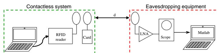
Figure II.4 – Chaîne de mesure pour l'eavesdropping
