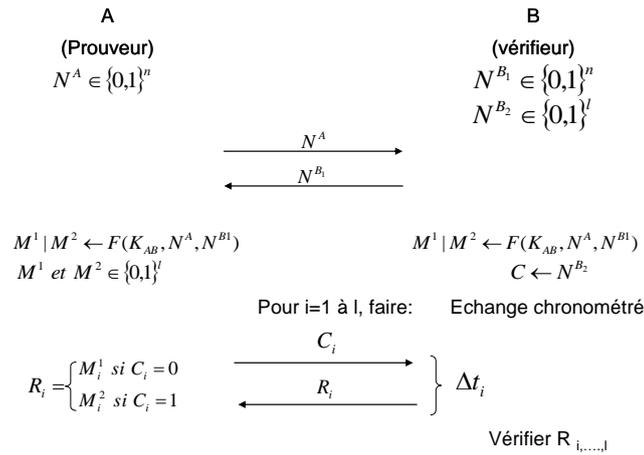
Figure III-1 – Protocole distance bounding par Hancke (2005)
