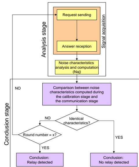
Figure IV-46 – Phase d'analyse et de conclusion
