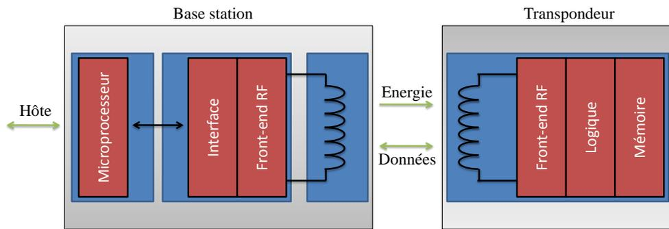
Figure I-5 – Structure d'un système sans contact [PAR2003]
