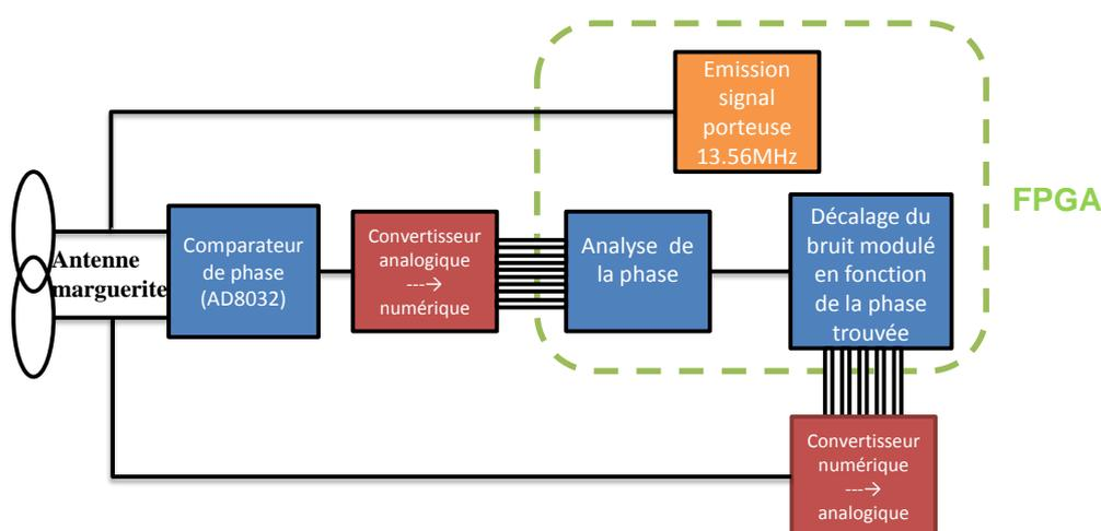
Figure V.29 – Synoptique du système de mesure et d'analyse
