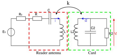
Figure IV-1 – Modèle électrique d'un système sans contact
