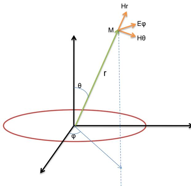
Figure II.1 – Champ électromagnétique à une distance  $r$  de l'antenne d'émission
