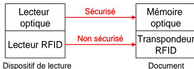
Figure I-24 – Système combinant RFID et mémoire optique
