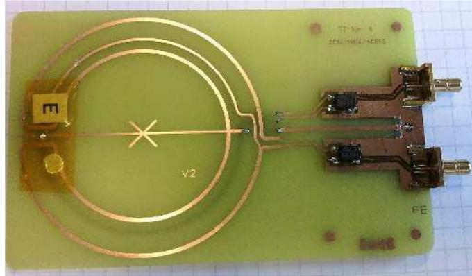
Figure Annexes-2 – L'antenne double boucle
