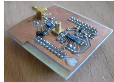
Figure V.32 – PCB du circuit de contrôle de gain
