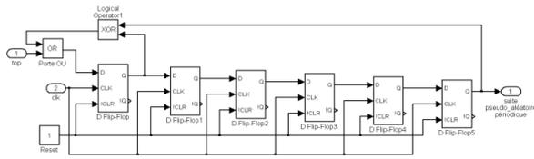
Figure III-50 – Implémentation d'un LFSR sous Simulink
