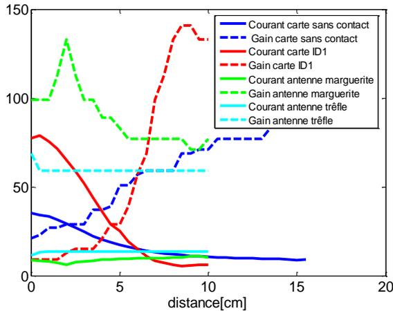
Figure IV-74 – Comparaison du courant et du gain obtenus pour différentes antennes de relais
