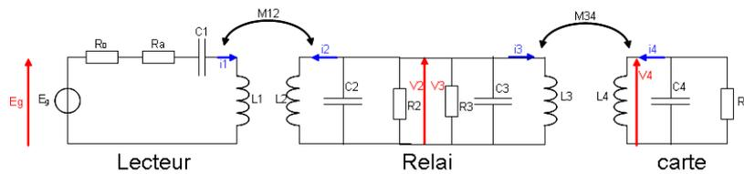
Figure II.33 – Système sans contact avec relais filaire
