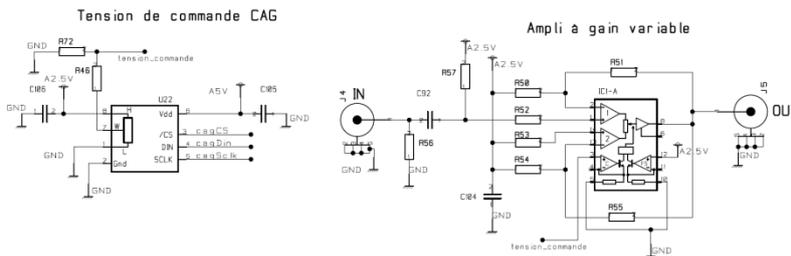
Figure V.31 – Electronique du circuit d'optimisation du gain
