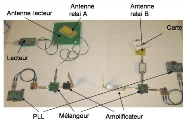
Figure II.31 – Photo du relais superhétérodyne (voie montante)
