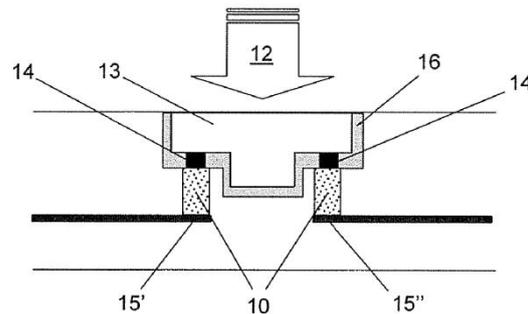
Figure I-26 – Interrupteur élastomère résistif (vue en coupe)
