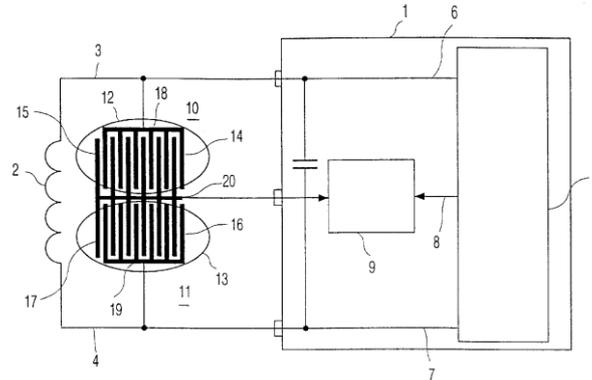
Figure I-27 – Système capacitif utilisé comme interrupteur
