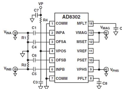
Figure V.28 – Composant de mesure de phase
