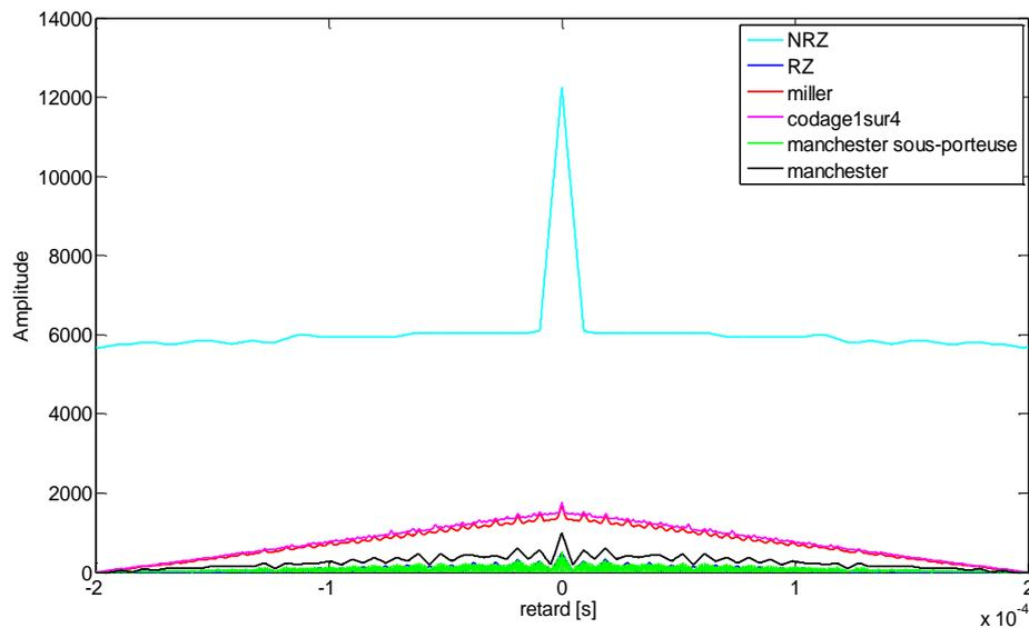
Figure III-19 – Fonction d'autocorrélation des différents signaux
