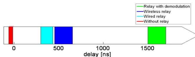
Figure II.43 – Vue globale des délais induits par le relais
