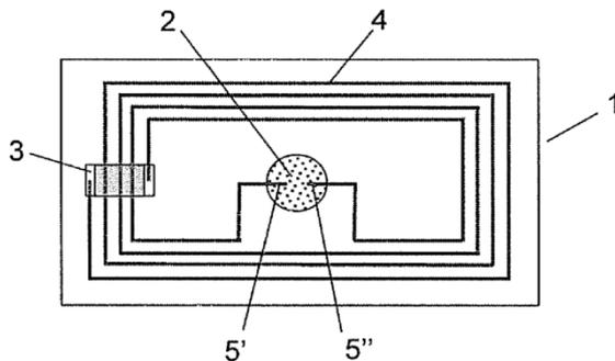
Figure I-25 – Interrupteur élastomère résistif (vue de dessous)
