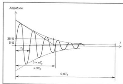
Figure IV-4 – Réponse impulsionnelle et caractéristiques temporelles [PAR2003]
