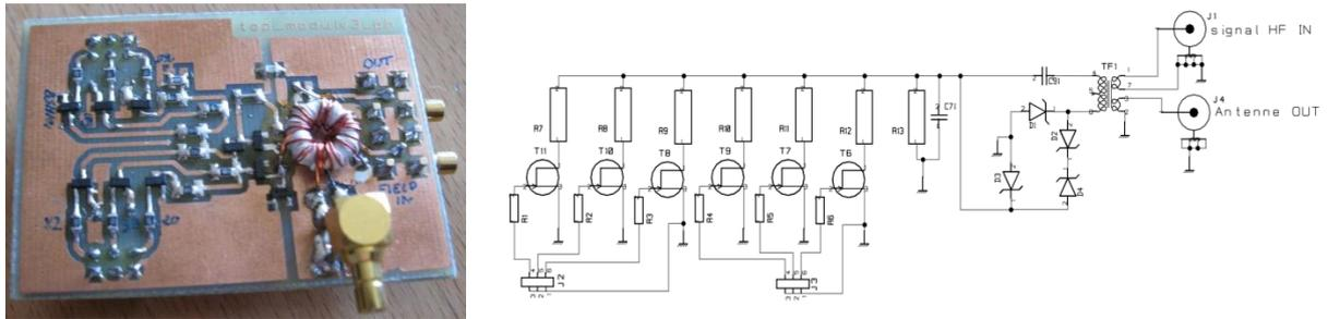
Figure Annexes-25 – Modulation d'amplitude du lecteur
