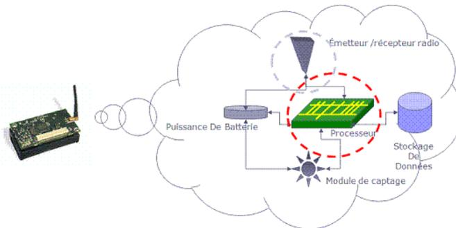
Figure IV-41 – Structure d'un capteur sans fil [TICE]
