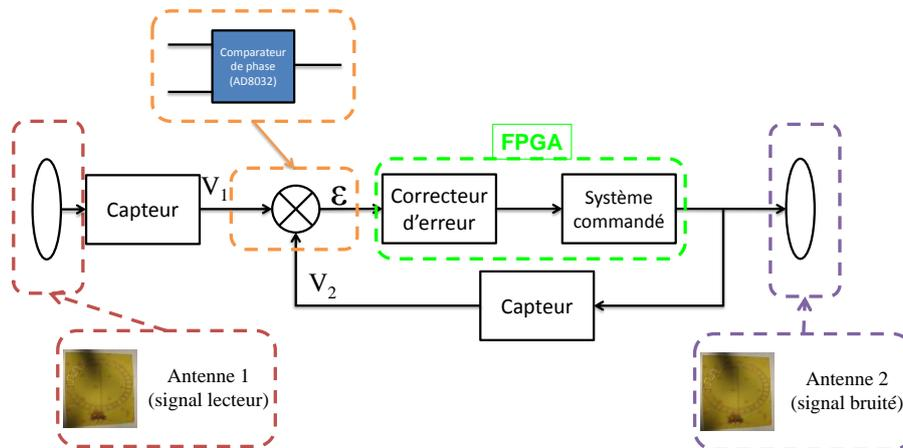
Figure V.30 – Asservissement du système en phase
