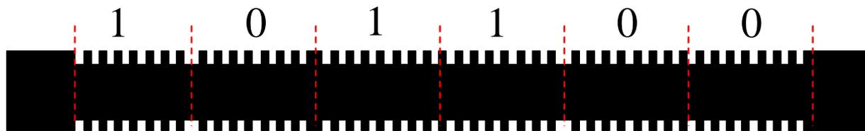
Figure V.6 – Codage et modulation ISO14443-B (Modulation : BPSK ; codage : NRZ-L)
