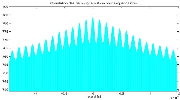
Figure III-24 – Corrélation à partir de signaux enregistrés sur l'oscilloscope pour les distances avec 0 cm entre les deux antennes.
