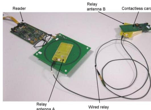
Figure III-37 – Expérimentations sur un relais filaire
