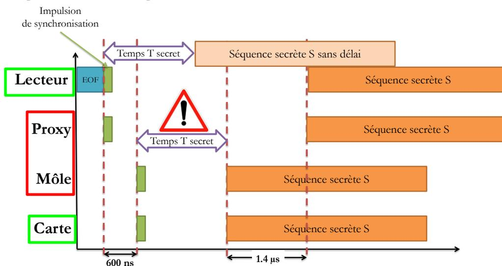
Figure III-41 – Attaque basée sur l'« overclocking »
