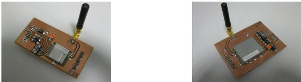
Figure II.52 – Systèmes de transmission TX et RX
