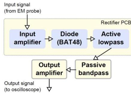
Figure I-21 – Système de démodulation analogique
