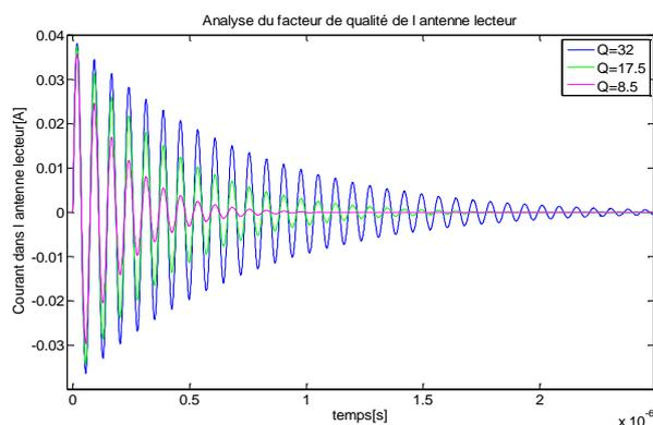
Figure IV-10 – Analyse du facteur de qualité de l'antenne lecteur (couplage nul)
