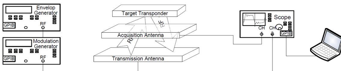
Figure I-33 – Système d'analyse des empreintes physiques
