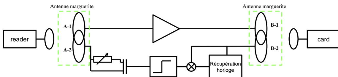
Figure II.27 – Topologie d'un système relais filaire avec démodulation
