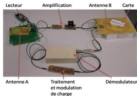
Figure II.28 – Photo d'un relais filaire avec démodulation
