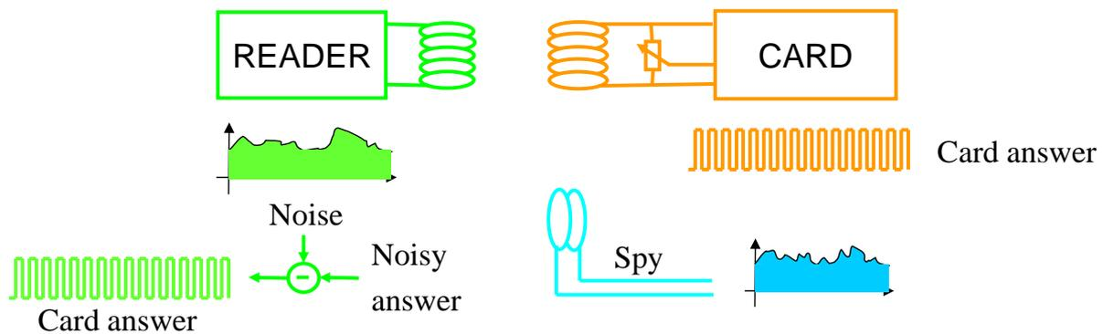
Figure I-23 – Système complet avec une sonde espion
