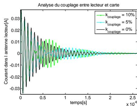
Figure IV-9 – Analyse des réponses en fonction du couplage
