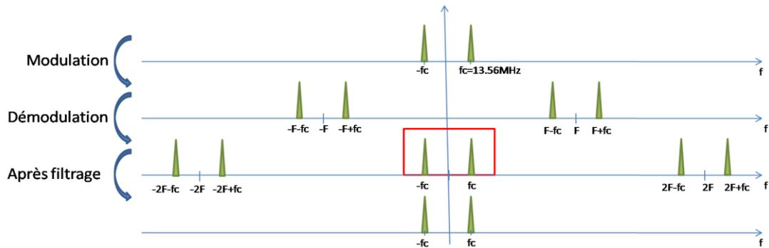
Figure II.30 – Modulation et démodulation du signal
