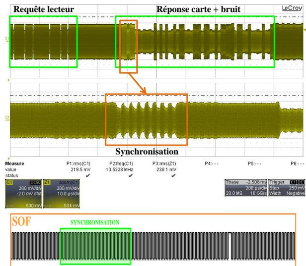
Figure V.24 – Phase de synchronisation en ISO15693
