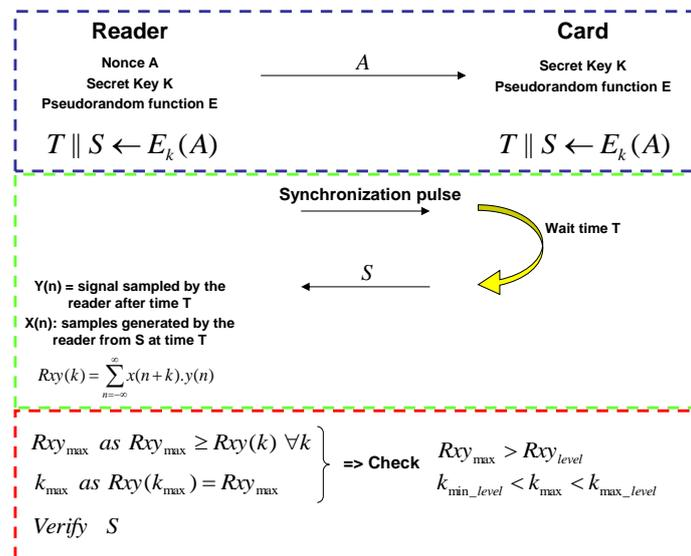
Figure III-29 – Protocole de notre système de détection
