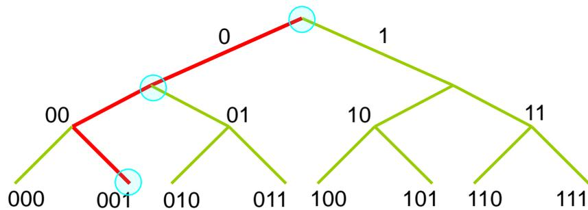
Figure I-16 – Tree Walking pour des UID de 3 bits
