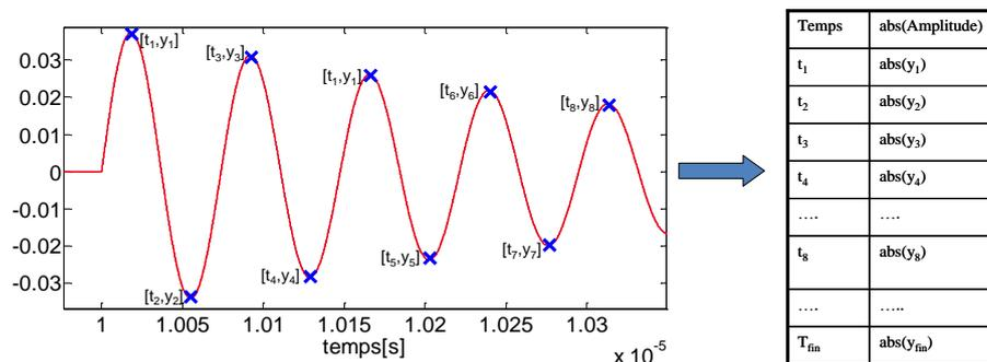
Figure IV-23 – Echantillonnage sur les extremums de la réponse
