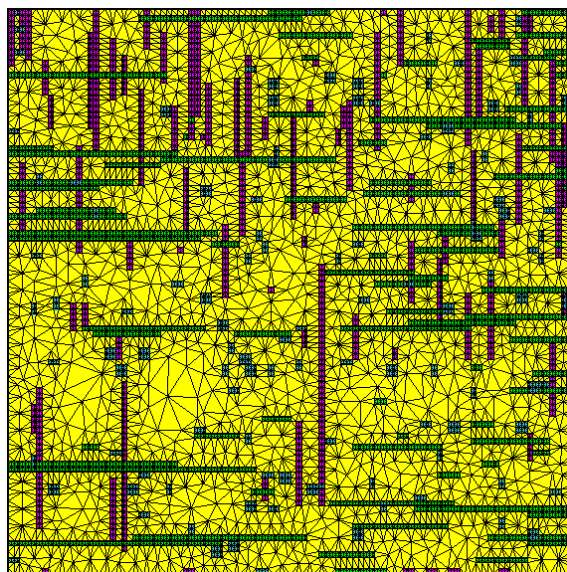
Figure 4 : maillage de VER avec trois orientations de NTC.
