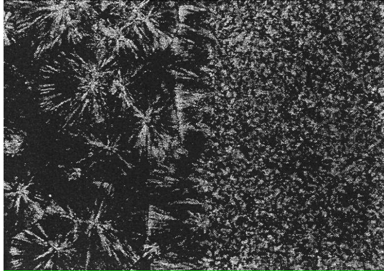
Figure 19 : photographie de microscopie optique en lumière polarisée de sphérolites d'un polypropylène vierge (à gauche) et d'un mélange PP/CaCO 3 (à droite) [Puk94].
