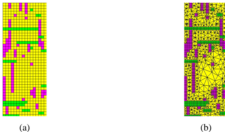
Figure 15 : raffinement du maillage NTC et remaillage de la matrice. (a) représentation initiale. (b) représentation après raffinement et remaillage.
