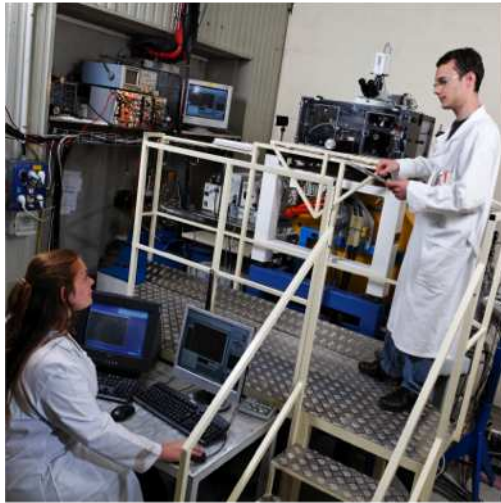
FIGURE 6.1: Vue générale du dispositif d'irradiation cellulaire et principe de collimation et d'irradiation. Le collimateur est placé immédiatement à la sortie d'un aimant dipolaire permettant d'obtenir un faisceau vertical.
