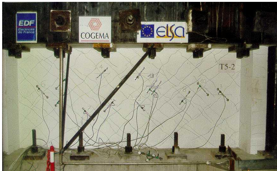
Figure IV-32 : Photo du voile T5 à la fin de l'essai correspondant à l'accélérogramme nominal
