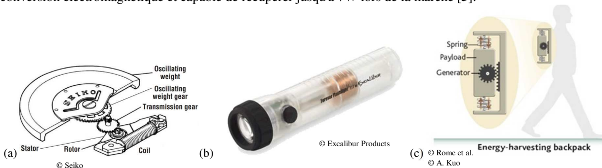
Figure 6. (a) Récupérateur d'énergie dans une montre ©Seiko [6] (b) système de récupération d'énergie inertiel pouvant être placé dans une poche ©Excalibur Products [7] et (c) sac à dos récupérateur d'énergie [5]
