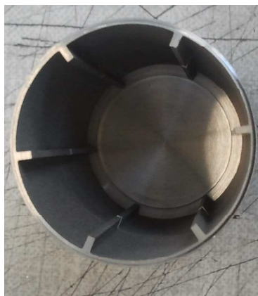
Figure V.3 : Intégration du MCP dans les étuis ( \varnothing accumulateur = 26 mm, \varnothing étui = 32 mm)
