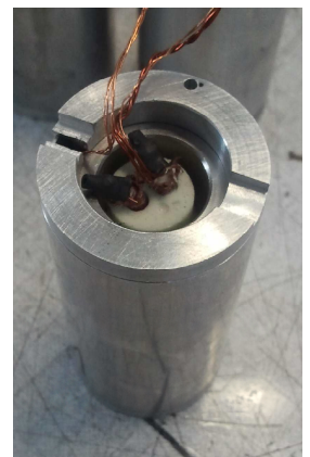
Figure V.3 : Intégration du MCP dans les étuis ( \varnothing accumulateur = 26 mm, \varnothing étui = 32 mm)
