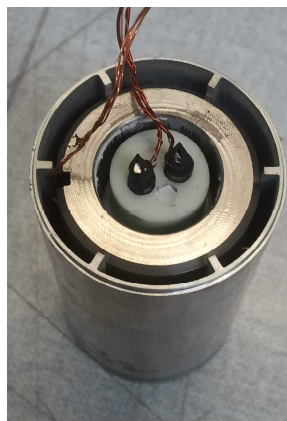
Figure V.3 : Intégration du MCP dans les étuis ( \varnothing accumulateur = 26 mm, \varnothing étui = 32 mm)
