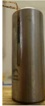
Figure IV.2: Élément équipé d'une cartouche chauffante et instrumenté pour la mesure de température et de tension
