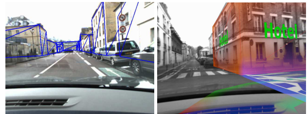
FIGURE 5 – Projection des modèles SIG dans l'image (erreur moyenne de 6 pixels) et guidage par réalité augmentée
