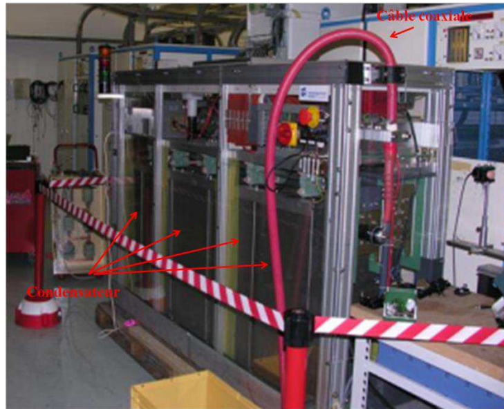
Figure 3.2 Générateur de courant conçu par le HZDR.
