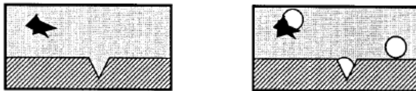
Figure II.2 : Type 2 : nucléation hétérogène classique, catalysée par la présence d'un autre matériau dans le liquide : à gauche, système avant sursaturation; à droite, après. [Jon99]
