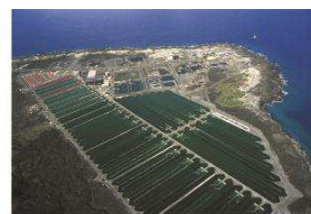
Raceways industriels (production d'asthaxanthine à partir de spirulines à Hawaii)
