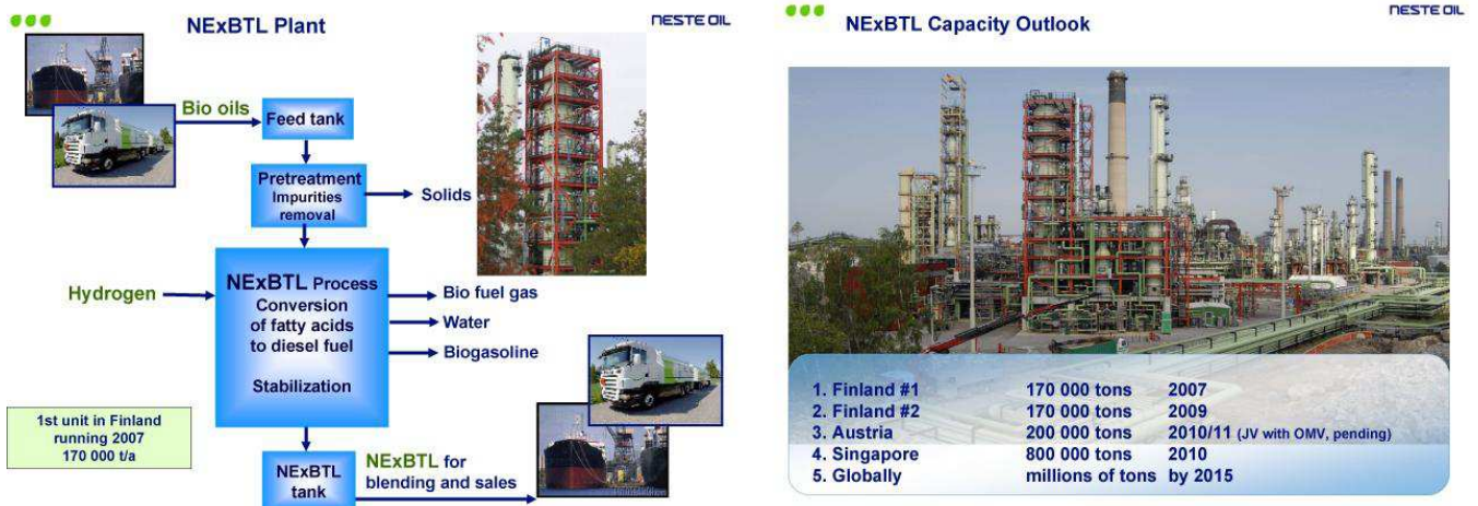
Le procédé NExBTL de Neste Oil - La plus grosse usine d'agrocarburant au monde fonctionne à base d'huile de palme et d'hydrogène.
