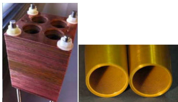
FIGURE 3.3.6: Cornets de l'instrument QUBIC. A gauche est représentée une matrice de 4x4 cornets constituées de plaquettes assemblées. A droite est montrée la corrugation des cornets.
