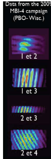
FIGURE 3.3.1: Résultats de la campagne MBI-4 de 2009. La fréquence et l'orientation des franges d'interférence sont en accord avec les simulations réalisées de l'instrument.
