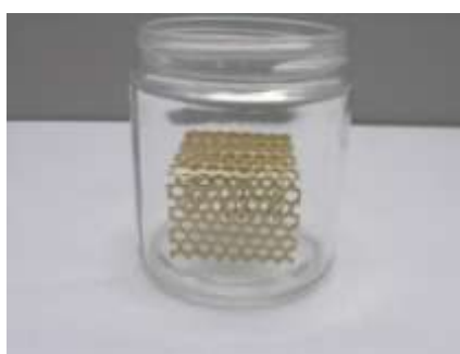
Figure 71. Cellule d'exposition statique des monolithes aux vapeurs saturantes d'eau. Le monolithe est déposé sur la grille en acier inoxydable. Le flacon de 6 cm de diamètre et de 6,8 cm de hauteur est rempli de 5 mL d'eau et fermé hermétiquement lors de l'exposition.
