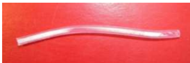
Figure 109. Tuyau bouché par la recondensation de l'acide nicotinique à la sortie de la chambre de perméation du four.
