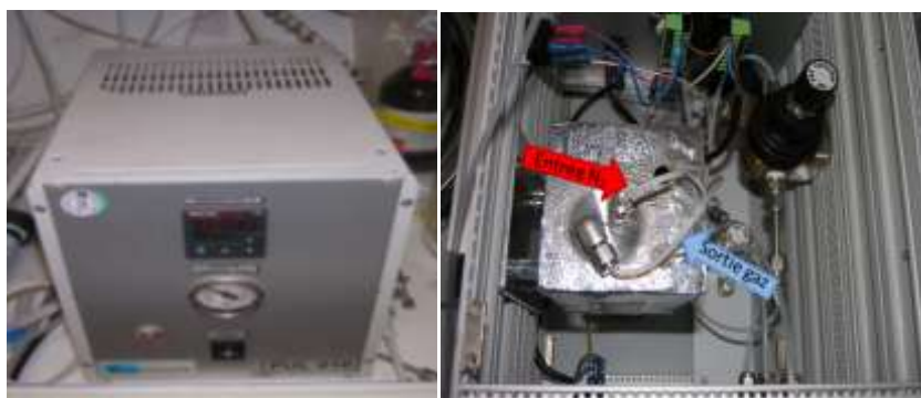
Figure 149. Vues externe et interne du four à perméation.
