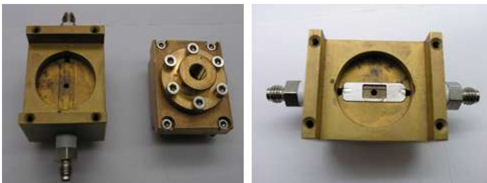
Figure 89. Gauche : cellule d'exposition avec le bloc porte-monolithe et le bloc de presse. Droite : zoom sur le bloc porte-monolithe. L'orifice central sert de passage au faisceau lumineux pour la mesure d'absorbance du monolithe.
