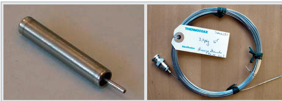
Fig. 104. Chambres à fission miniatures (4 mm et 1.5 mm).
