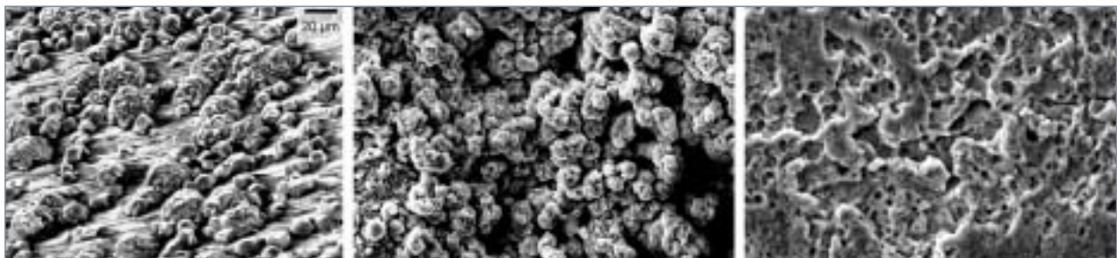
Fig. 159. Micrographies MEB des couches de sidérites : (à gauche), dépôt épars à la surface de l'acier ; (au centre), dépôt épais obtenu en pâte argileuse ; (à droite), dépôt compacté par le gonflement de l'argile MX80.
