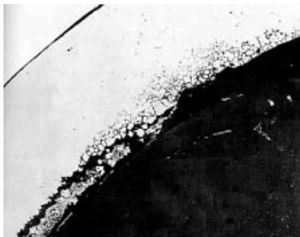
Fig. 109. Intense corrosion de jeunesse sans rupture de la gaine sur un élément combustible neutrons rapides irradié dans le réacteur RAPSODIE – FORTISSIMO.
