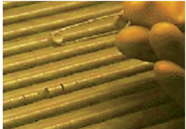
Fig. 3. Pastilles de combustible MOX, prêtes à être « engagées ».
