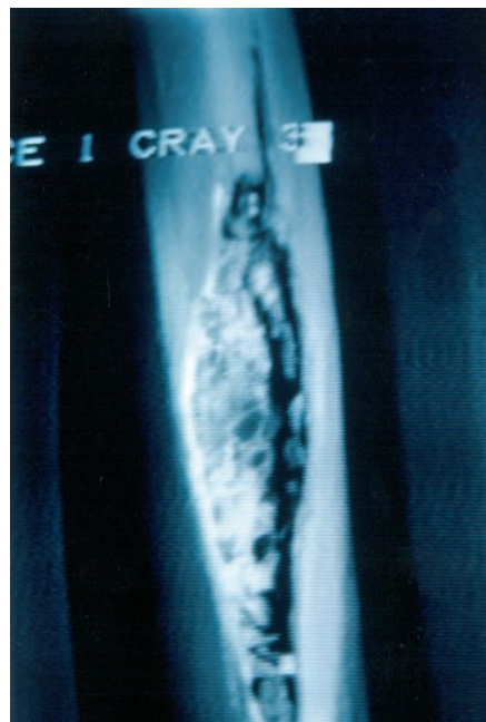
Fig. 21. Défaut d'étanchéité créé par hydruration.
