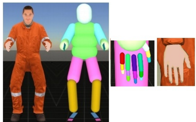
Figure 1: L'humain virtuel : habillage et géométrie de collision (à gauche). Modèle de main : habillage et géométrie de collision (à droite)
