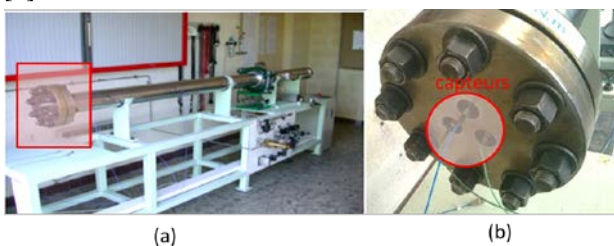
Figure 4. (a) Tube à choc du CEA Gramat et (b) montage du capteur en fond de tube.
