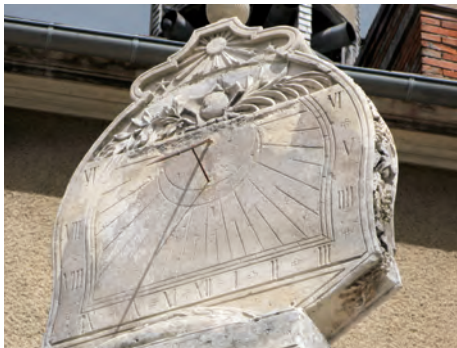
Fig. 3 : Cadran solaire installé en haut d'une colonne à Vermenton (Yonne). Daté de 1790, c'est un cadran orienté volontairement plein Sud. On voit nettement l'ombre de son style polaire (il pointe sensiblement vers l'Étoile polaire) qui indique l'heure solaire en recouvrant successivement les lignes horaires convergentes.
